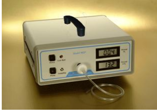
Şekil 3. 4. Karbondioksit/Oksijen analizörü, Quantec Instruments 902P
