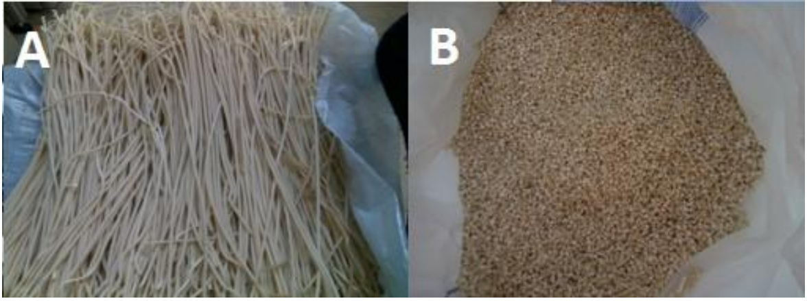
Şekil 4. 2. (A) Ekstrüderden çıkan polimer (B) Granül hale getirilmiş polimer
