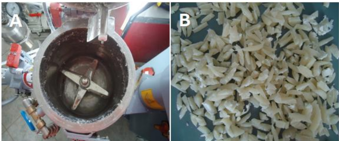
Şekil 4. 1. (A) Karıştırıcı (B) Karıştırıcıdan çıkan Nişasta-g-LA karışımı
