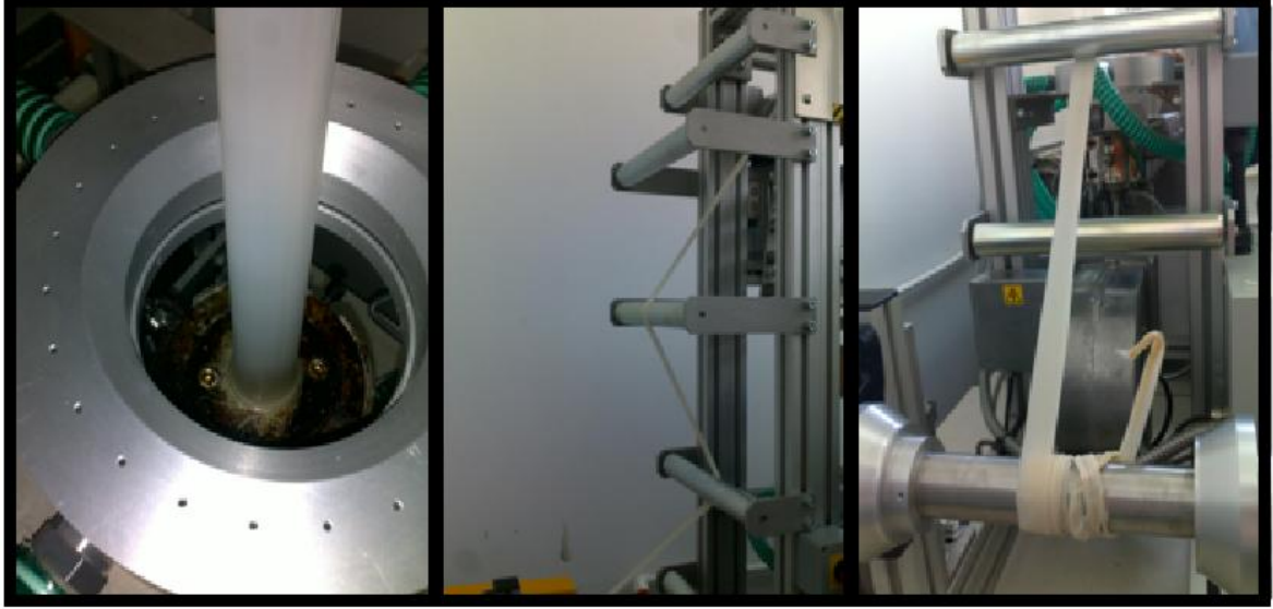
Şekil 4. 3. Üfleme şişirme prosesi ve üfleme şişirme cihazı
