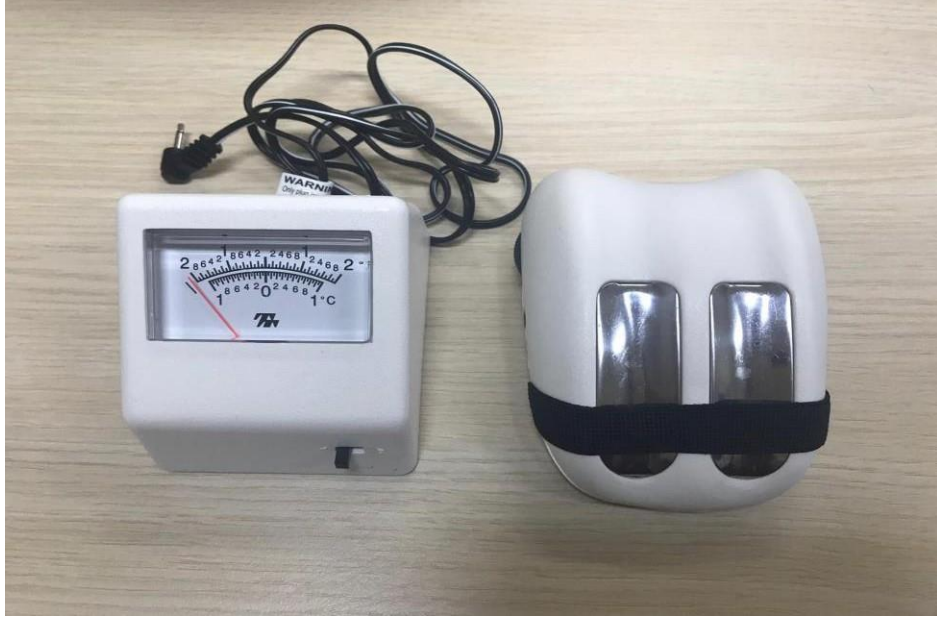
Şekil 3.3. Galvanic skin response (GSR) 2 cihazı
