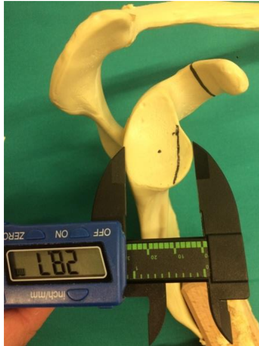
Şekil 20. Plastik skapula modelinde glenoidin en geniş AP çapının ölçülmesi.
