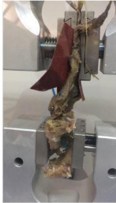
Şekil 33. Kadavra skapulasının biyomekanik test sırasındaki görünümü
