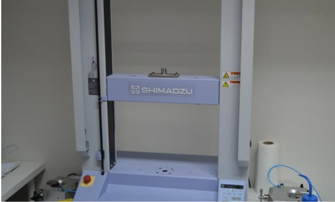
řekil 24. Biyomekanik testler iin kullanılan test cihazı (SHIMADZU UNIVERSAL TESTER 5kN)
