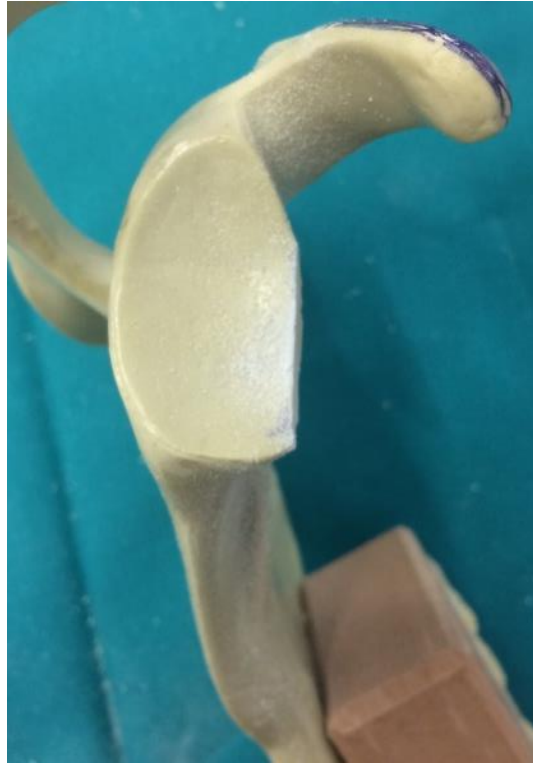
Şekil 22. Plastik skapula modelinin glenoid anteroinferiorunda %25'lik defekt oluşturulmuş hali.
