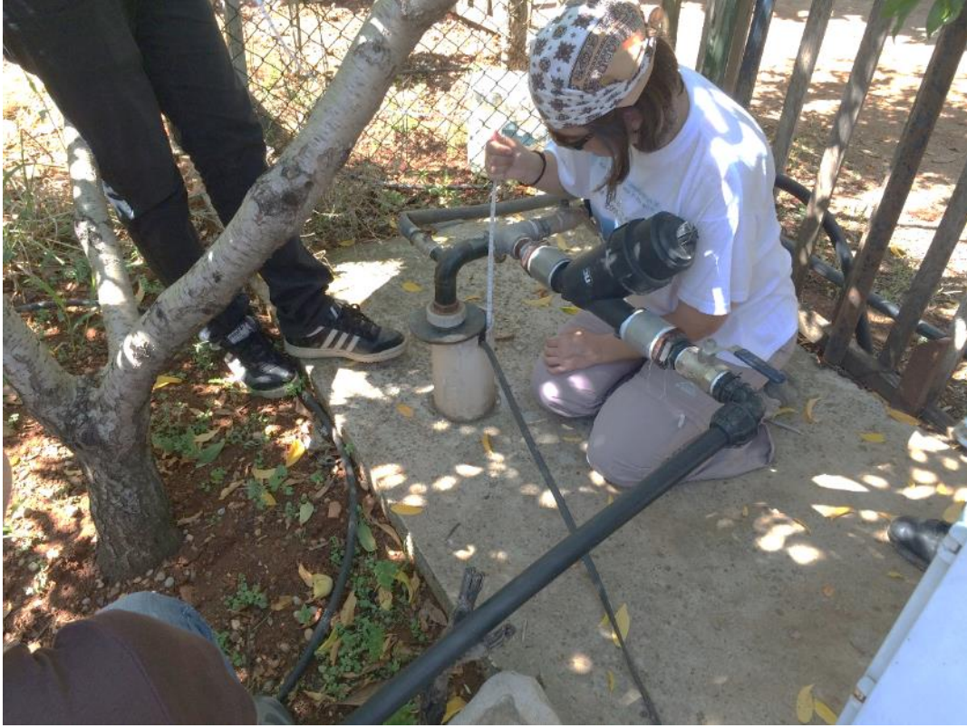
Şekil 3.2. Arazide yeraltısuyu kotu ölçümleri.
