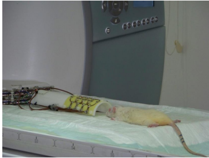
Resim 14. Sıçan ve sıçan için geliştirilen sarmal.
