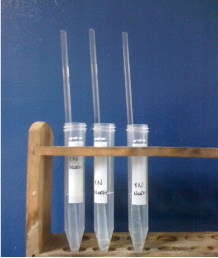
Resim 3.1. 4.1 mm Kalınlığındaki Bagetler Kitosan Çözeltilerine Daldırıldıktan ve Uygun Kalınlık Elde Edildikten Sonra 24 Saat Süreyle 1n Naoh'ta Bekletilmesi.
