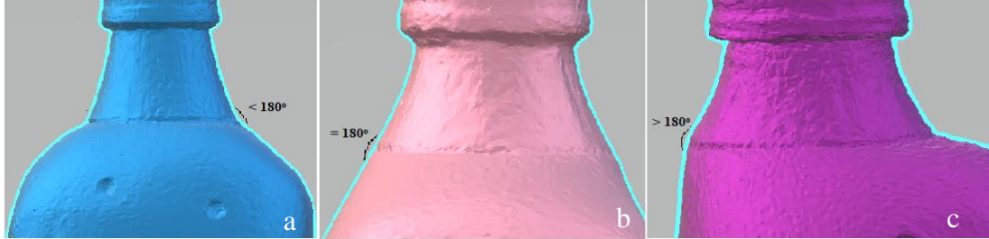
Şekil 3.16. İçbükey K-D geçiş geometrisi (a), düz K-D geçiş geometrisi (b) ve dışbükey K-D geçiş geometrisi (c)
