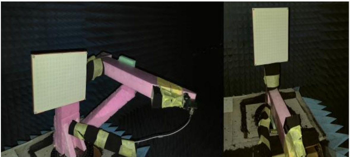
Şekil 4.18 - Çok katmanlı anten (a) H-düzlemi, (b) E-düzlemi ölçüm düzenekleri
