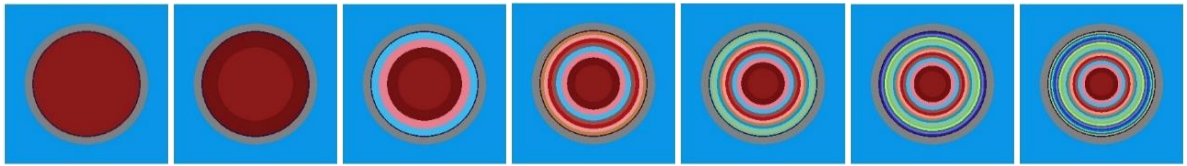
Şekil 4.5. PWR yakıt birim hücresinin 1, 2, 4, 8, 12, 16 ve 20 eş hacimli bölgeye ayrılmış görünümü
