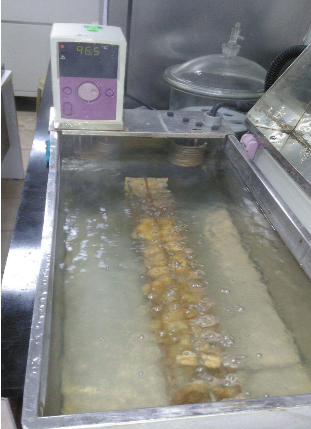
Fotoğraf 3.8 - Kaynatma deneyinin su banyosunda yapılışı ( foto: Ferhat ÇAKMAK )
