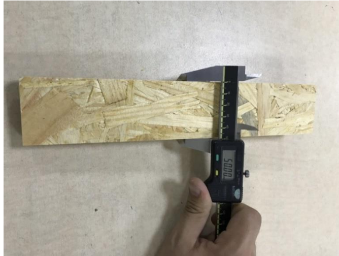
Fotoğraf 3.3 - OSB'lerin genişlikleri TSE'ye ait kalibrasyonlu kumpas yardımıyla ölçülmüştür. ( foto: Ferhat ÇAKMAK )
