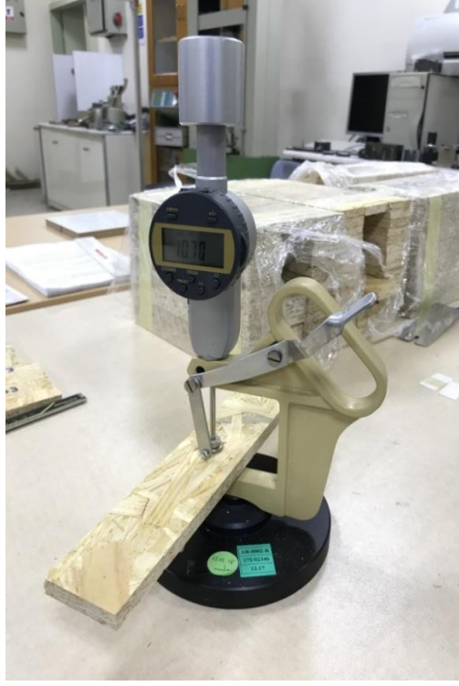
Fotoğraf 3.2 - OSB'lerin kalınlıkları TSE'ye ait kalibrasyonlu mikrometre yardımıyla ölçülmüştür. ( foto: Ferhat ÇAKMAK )
