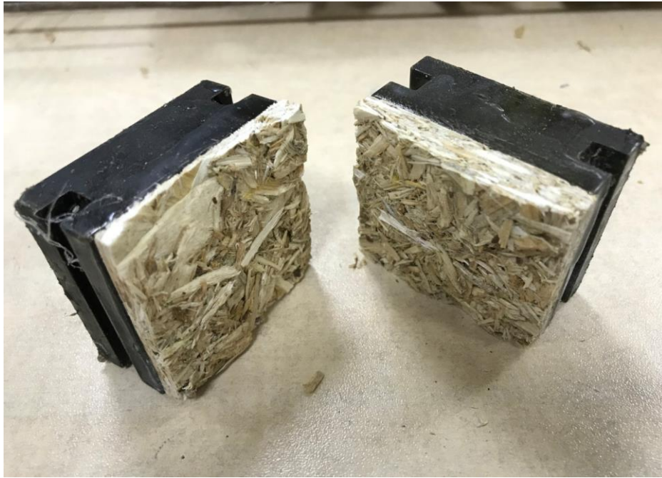
Fotoğraf 4.3 - İç yapışma testi sonrası OSB numunesi ( foto: Ferhat ÇAKMAK )
