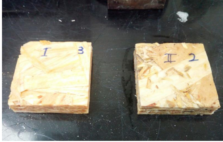
Fotoğraf 4.4 - Kalınlığına şişme – 24 saat süreyle daldırma testi sonrası su banyosundan çıkarılan numuneler. ( foto: Ferhat ÇAKMAK )
