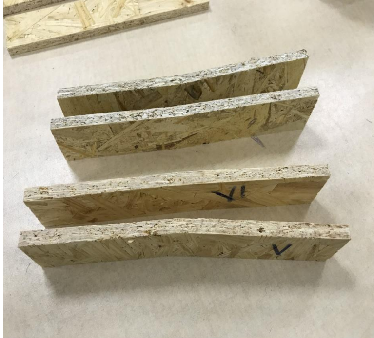
Fotoğraf 4.1 - Eğilme mukavemeti ve eğilmede esneklik modülü testi sonrasında numune örnekleri ( foto: Ferhat ÇAKMAK )
