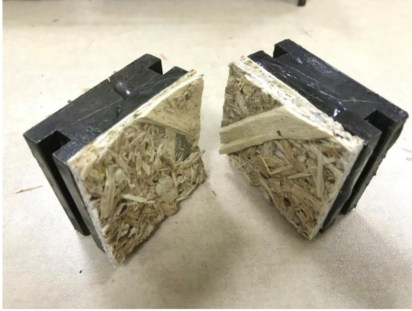
Fotoğraf 4.2 - İç yapışma testi sonrası OSB numunesi ( foto: Ferhat ÇAKMAK )
