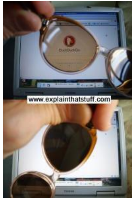
Görüntü 12: Polarize gözlükle ters açıdan bakılması sonucu karamış gözükten LCD ekran görüntüsü.
