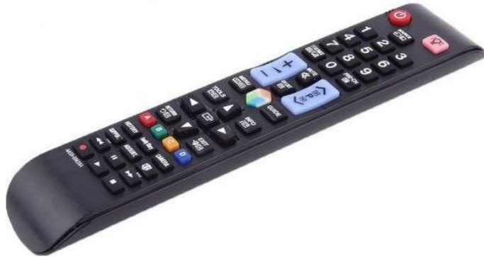
Görüntü 1: TV kumandası üzerinde ses ve program tuşları. Fiziksel olarak daha büyük ve eğimlidir. ( https://images-na.ssl-images-amazon.com/images/I/819nV8F4T0L._SL1500_.jpg )
