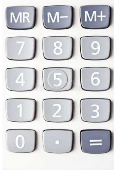
Görüntü 3: Hesap makinesi tuşları, 5 tuşuna kabartı eklenmiştir.
