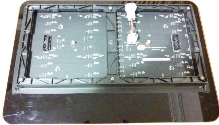
Görüntü 55: Adafruit'in RGB Matrix 32X64 paneli arka görünüşü ve güç bağlantısı
