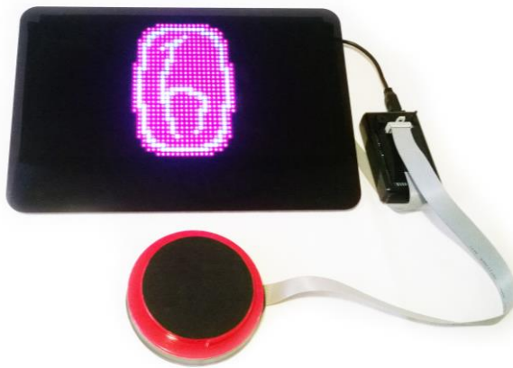
Görüntü 67: Somut platformun bağlantıları yapılmış yazılım yüklenmiş ve logo görüntüsü test edilmiştir.
