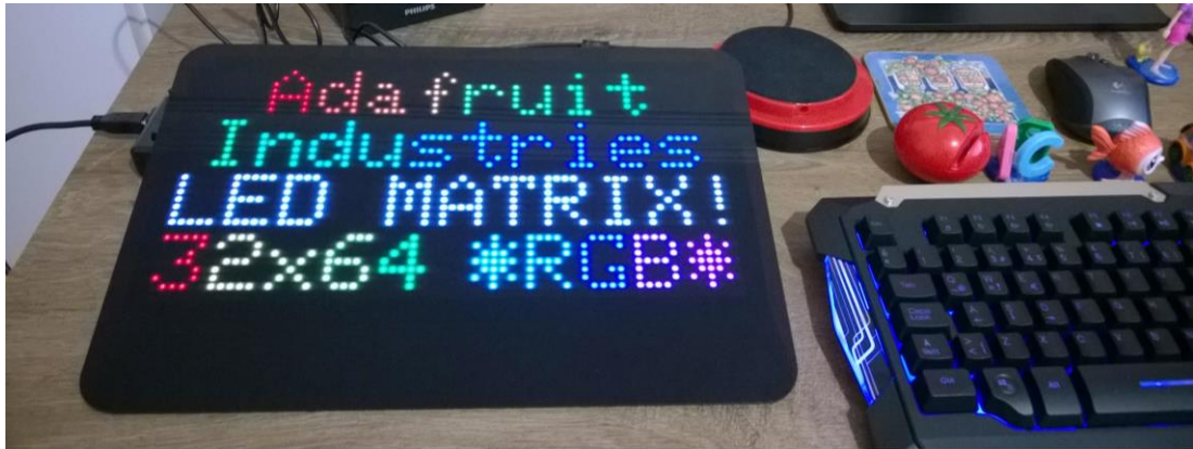
Görüntü 53: RGB 32X64 matrix ekran, koruyucu panel var, okunabilirlik yüksek.
