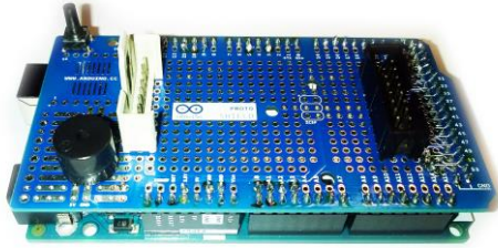
Görüntü 62: Arduino PROTO SHIELD'in, Arduino MEGA ile birleştirilmiş ve bitmiş hali.
