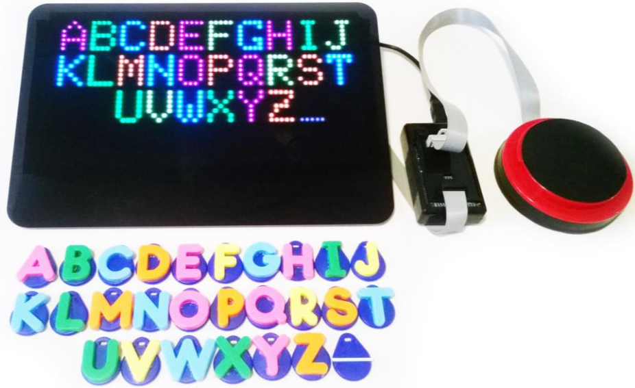
Görüntü 68: Somut platformun logo açılışından sonra ekrana alfabe harfleri gelmektedir. Ekran ile aynı renk kodlanmasına sahip somut harfler ve ekran görüntüleri.
