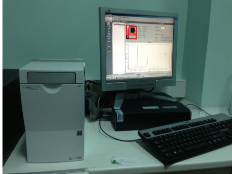
Şekil 3. 6. Biyoanalizör ile otomatik mikroakışkan Agilent elektroforez 2100 biyoanalizör
