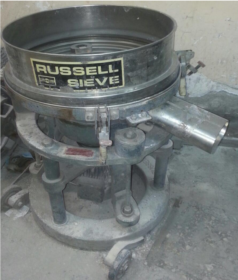
Şekil 4.7. Laboratuvar ölçekli titreşimli elek (Russel)
