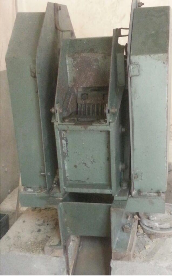
Şekil 4.4. Laboratuvar ölçekli çeneli kırıcı
