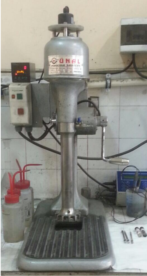
Şekil 4.10. Laboratuvar Ölçekli Flotasyon Hücresi
