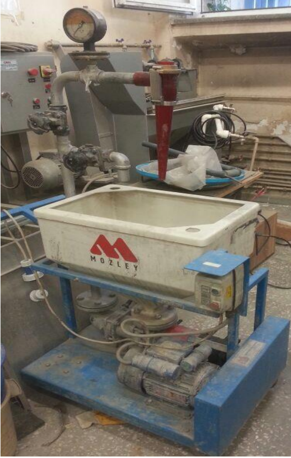
Şekil 4.8. Laboratuvar ölçekli hidrosiklon
