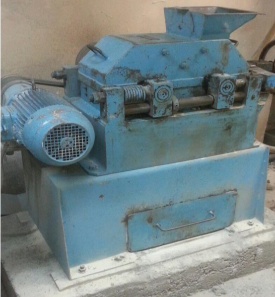
Şekil 4.5. Laboratuvar ölçekli merdaneli kırıcı
