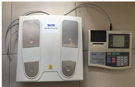
Şekil 3.1. Biyoelektrik impedans analizörüne entegre elektronik baskül (Tanita TBF-401A USA) cihazının fotoğraf görüntüsü.
