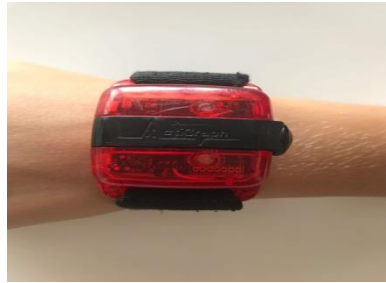
Şekil 2.1. ActiGraph marka wGT3X-BT kablosuz akselerometre cihazının gösterimi.
