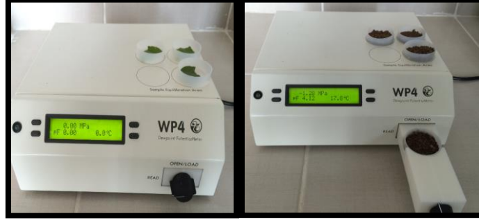
Şekil 3.5. WP4 Dewpoint Potential Meter cihazının genel görünümü
