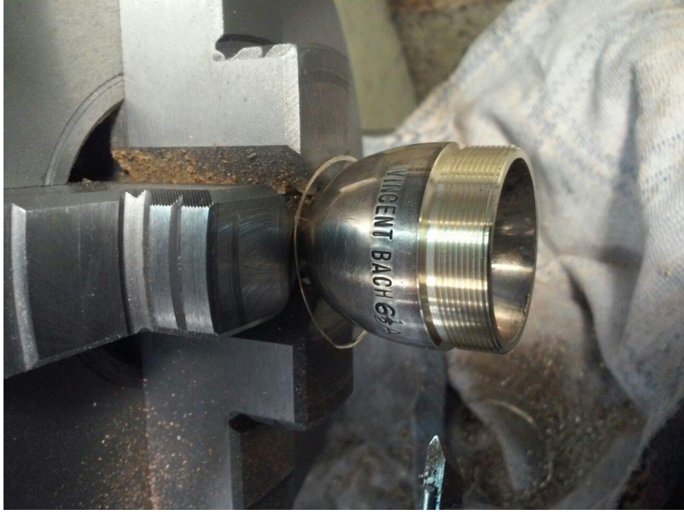
Resim 9. Uygulamada çerçevesi kesilerek yiv açılan ağızlık
