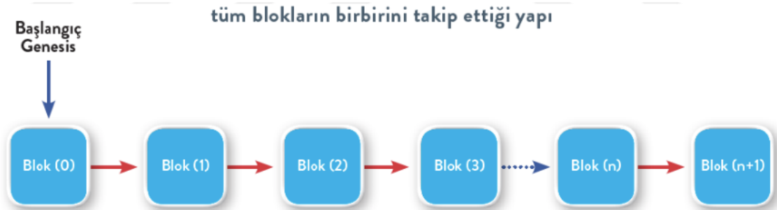
Şekil 4. Blokzincirinin İşleyiş Mekanizması 66
