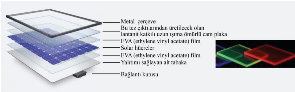
Şekil 4.11. Bu Tez Çıktılarında Tasarlanan Hibrit Güneş Paneli
