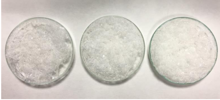
Şekil 4.30. Proses I koşullarında solüsyon D, E ve F için vakum kurutma sonrası görselleri (soldan sağa: solüsyon D, solüsyon E, solüsyon F)
