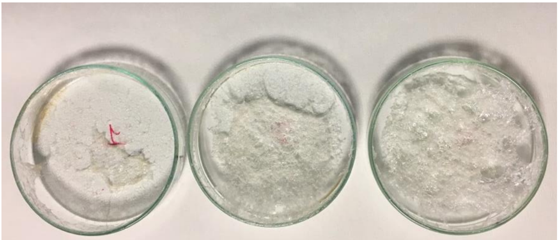
Şekil 4.24. Proses I koşullarında solüsyon A, B ve C için vakum kurutma sonrası görselleri (soldan sağa: solüsyon A, solüsyon B, solüsyon C)
