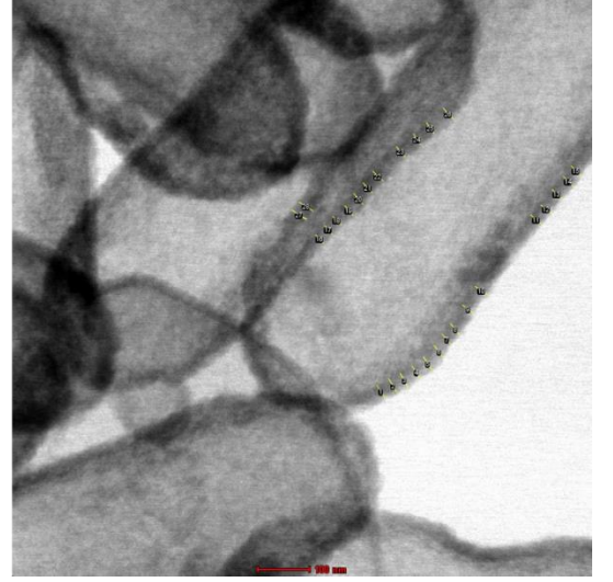
Şekil 52. Oval Şekilli İçi Boş SiO 2 Parçacıkların HR-TEM Görüntüsü ve Kalınlık Histogramı
