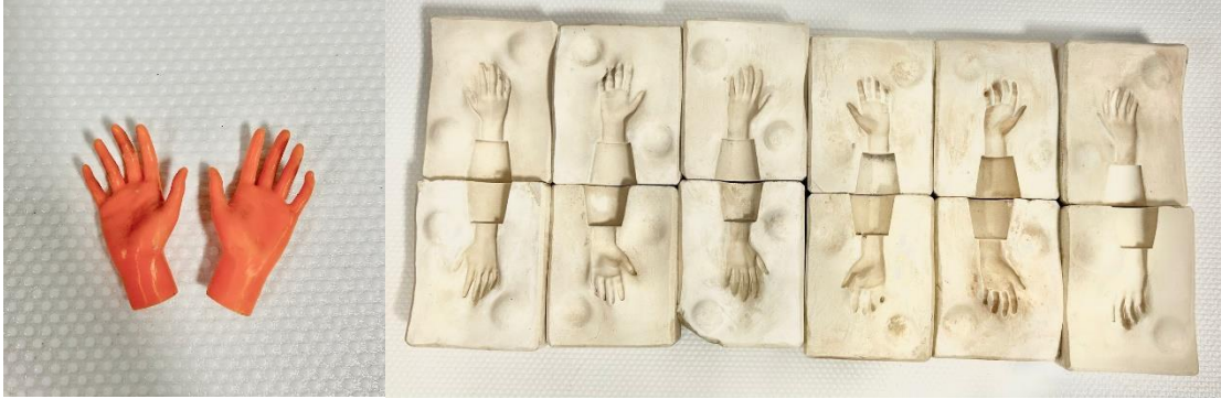
Görsel 24. 3D yazıcıdan çıkan el modelleri ve alçı kalıpları
