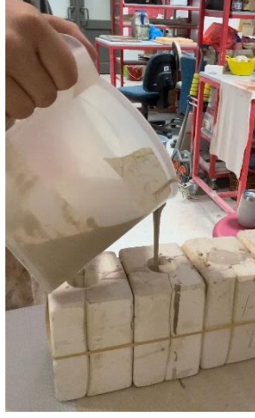
Görsel 26. Alçı Kalıplar Döküm Yapılması
