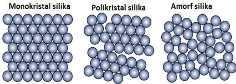
Şekil 2.2. Monokristal, polikristal ve amorf silika allotroplarının şematik yapısı
