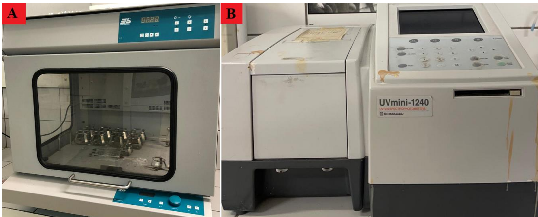
Şekil 3. 6. A) Çalkalamalı etüv (Edmund Bühler TH-30/SM30, Almanya), B) UV-VIS spektrofotometre (UV-1240, Shimadzu, Japonya).
