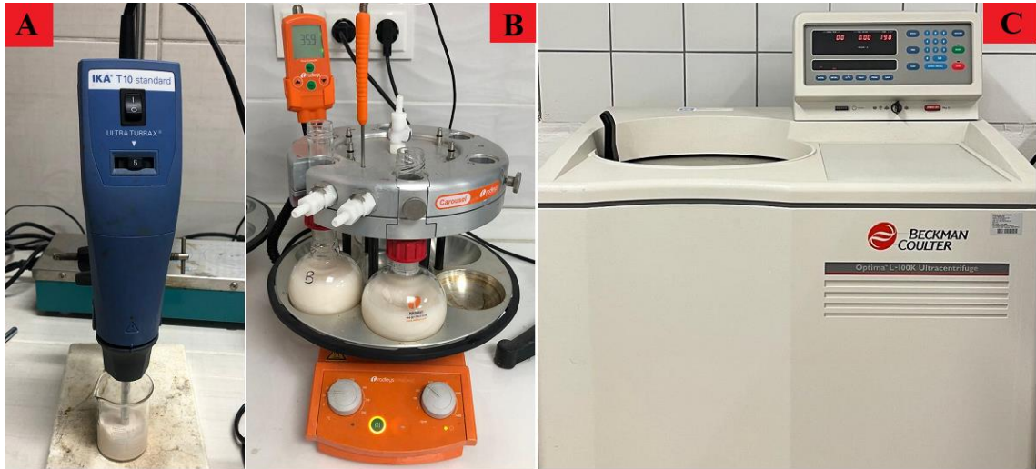
Şekil 3. 3. A) Homojenizatör (T10, Ika Labortechnik, Almanya), B) Polimerizasyon reaktörü (Radleys Carousel 6, UK), C) Ultrasantrifüj (Beckman Coulter Optima L-100K).
