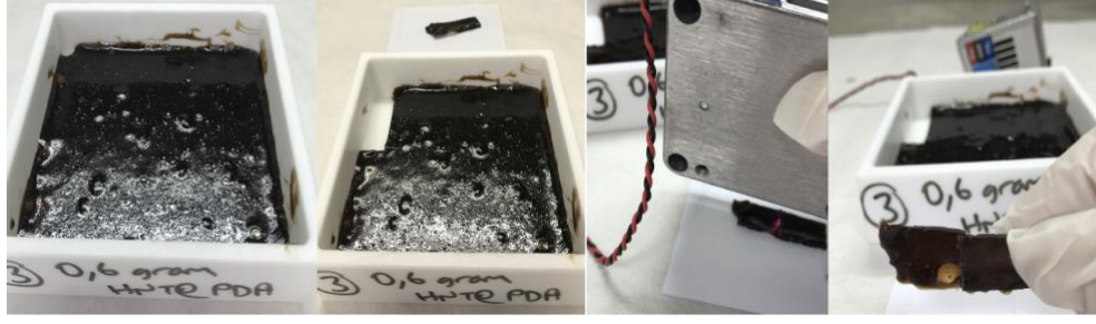
Şekil 4.27. 0.6 gram HNT@Polidopamin içeren nanokompozit hidrojelin NIR ışık ile kendi kendini onarımı
