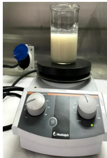
Şekil 3.6. Halloysit Nanotüp (HNT) dispersiyonu
