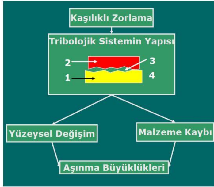
Şekil 3.17. Tribolojik sistemin şematik gösterimi.
