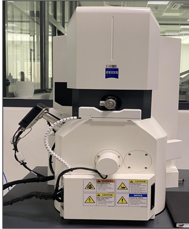
Şekil 3.9. ZEISS SEM/EDS cihazı.
