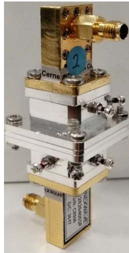
Şekil 6.33. Montajı tamamlanan ölçüme hazır çapraz irisi ayar vidasız ÇMDRF Filtre, Şekil 6.34'te gösterilen test düzeneğinde ölçülmüştür:
