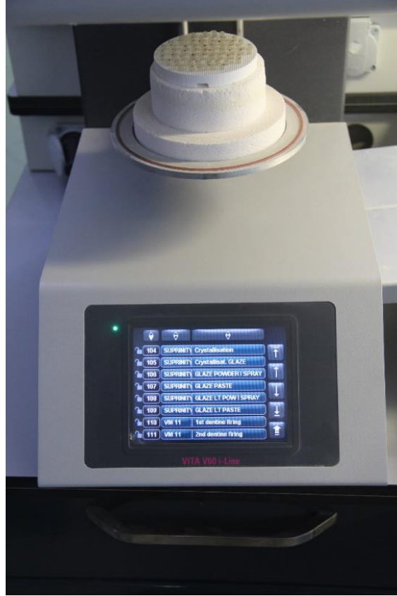
Şekil 3.12. VITA Suprinity seramik örneklerin kristalizasyon fırınlanması
