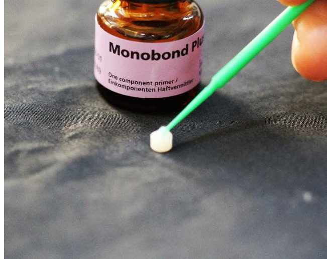
Şekil 3.18. Seramik örneklere Monobond Plus uygulanması
