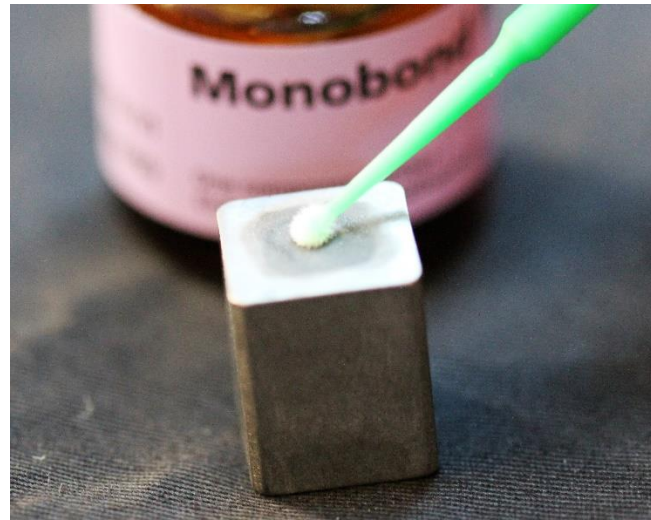
Şekil 3.19. Titanyum örneklere Monobond Plus uygulanması
