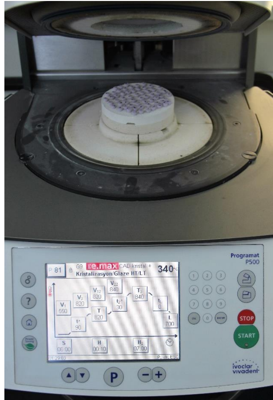
Şekil 3.11. IPS e.maxCAD seramik örneklerin kristalizasyon fırınlaması
