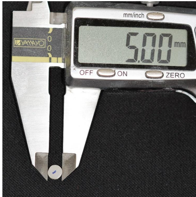
Şekil 3.15. Seramik kalınlıklarının dijital kalınlık ölçer yardımı ile ölçülmesi
