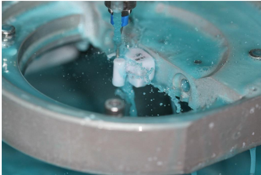
Şekil 3.4. Yenadent D30 Cihazında Silindir Bloğun Kazınması
