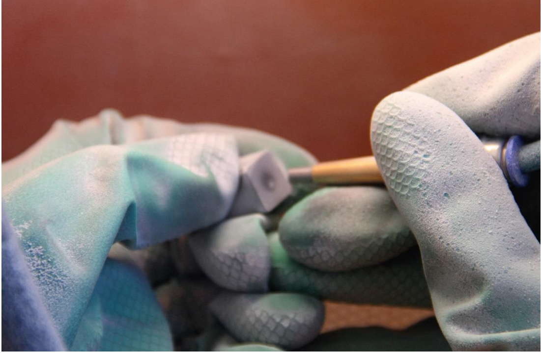
Şekil 3.13. Titanyum örneklerin polisajlı yüzeylerine Cojet uygulanması
