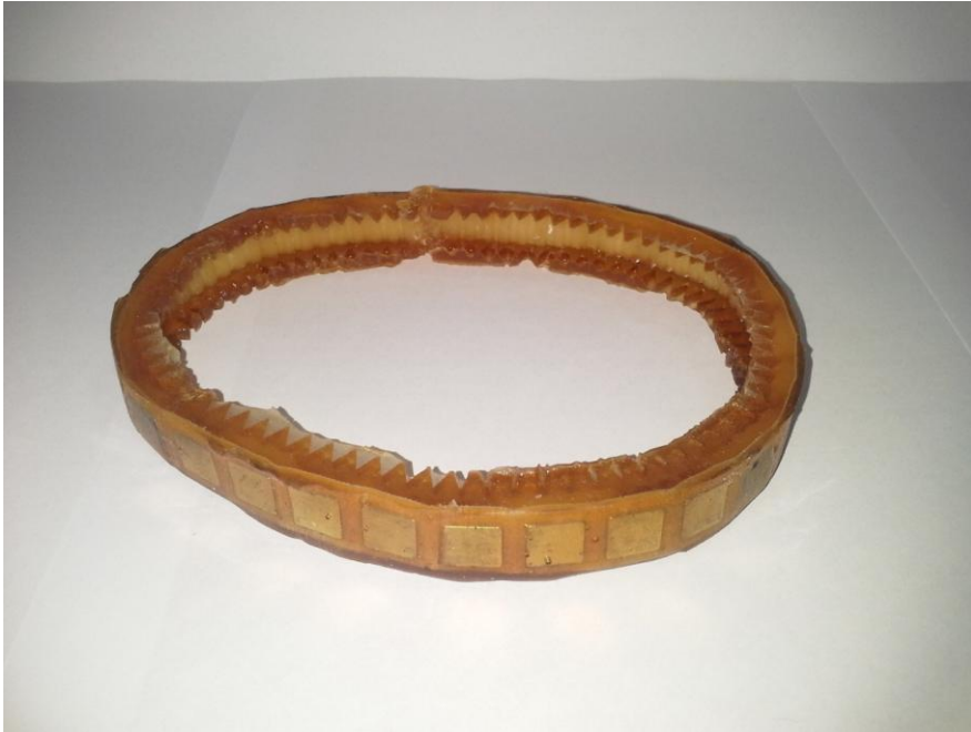
Şekil 3.15 Vytaflex@10 ve Vytaflex@20 hibrid dökümü
