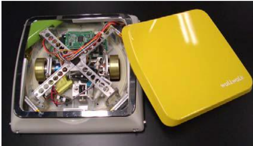
Şekil 2.6 Cam yüzeyler üzerinde çalışan WallWalker robotu
