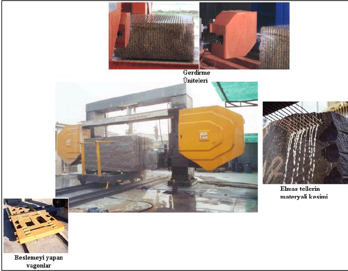
Şekil 2.8 Çoklu elmas telli kesme makinası ve parçaları [1]
