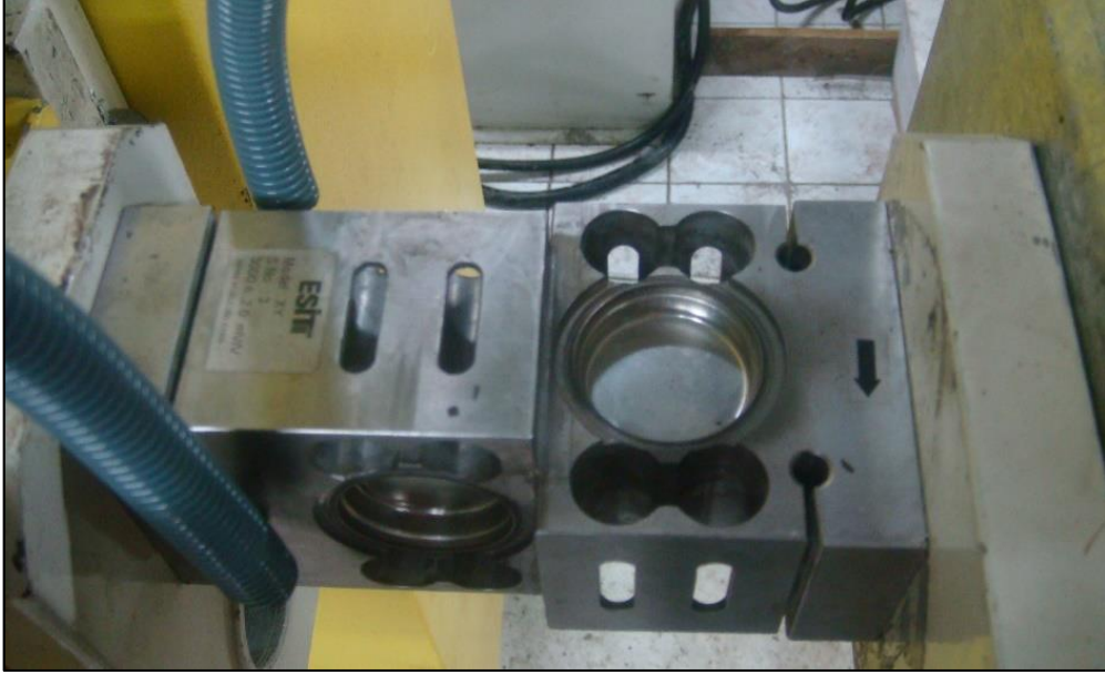
Şekil 3.17. Yönleri değiştirilen yük hücreleri
