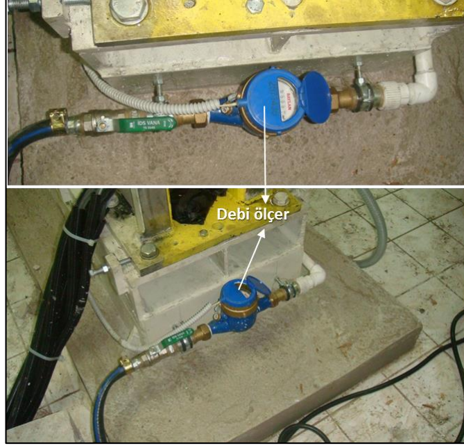
Şekil 3.9. Harcanan su miktarını belirlemede kullanılan debi ölçer
