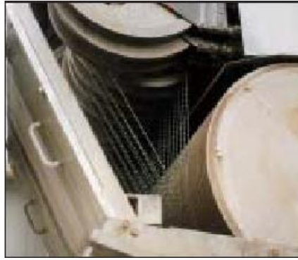
Şekil 2.6. Elmas tellerin gerilimini koruyan mekanizma [1]
