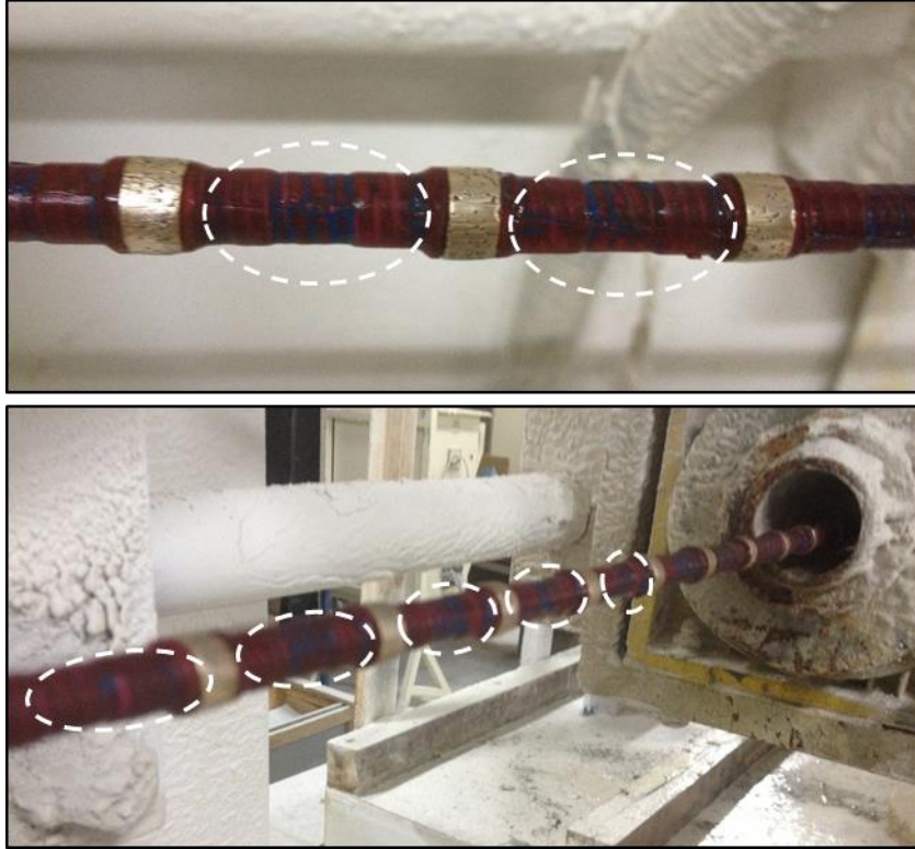
Şekil 4.15. Sprey boya ile işaretlenmiş olan boncuklar
