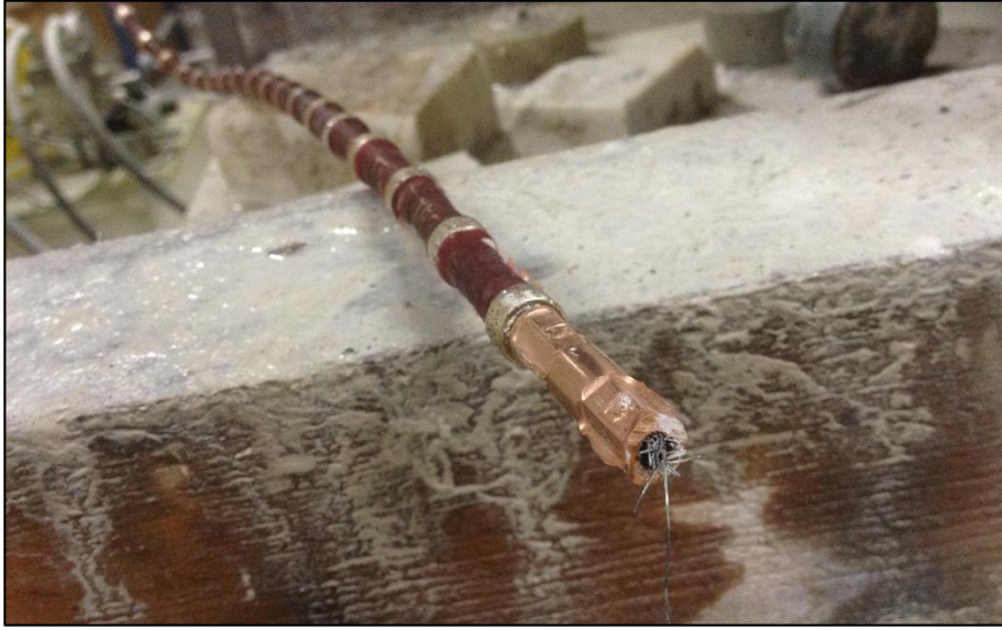
řekil 3.19. Kesim sırasında kopan bir elmas tel grnts
