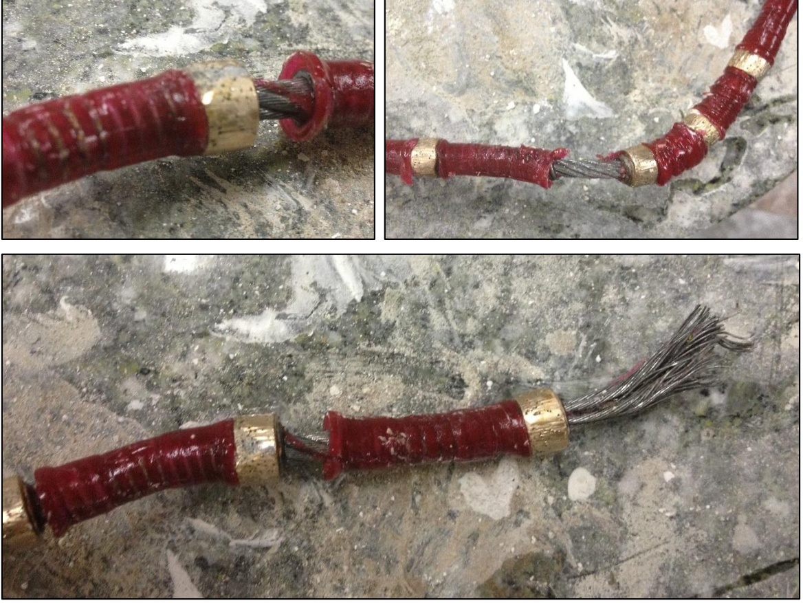
Şekil 3.20. Deneme kesimlerinde elmas telde görülen hasarlar
