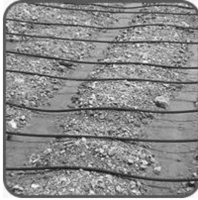
Şekil 4-6 Yığın Liçinde Kullanılan Damlatma Sistemi
