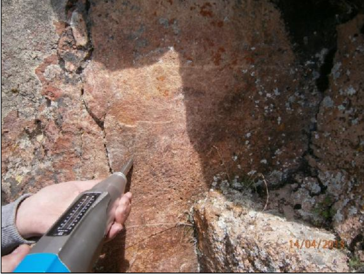
ekil 5-11 Çalı ma arazisinde süreksizlik yüzeylerinde Schmidt çekici uygulaması.
