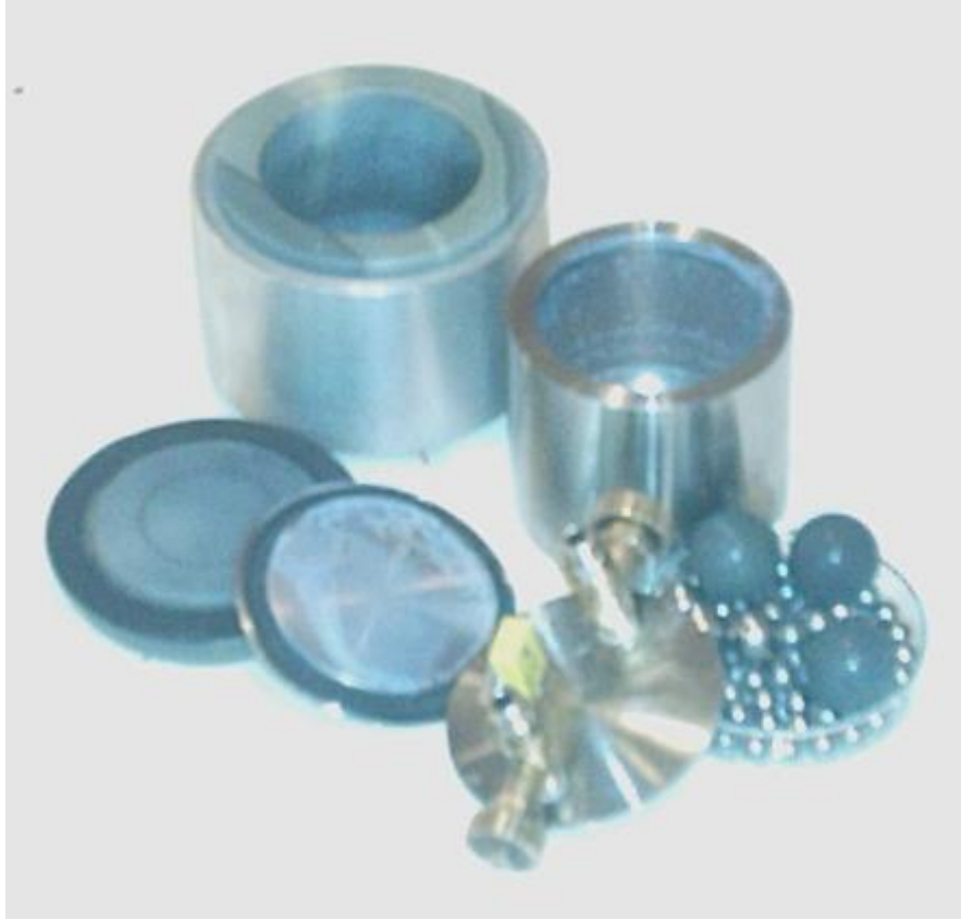
Şekil 19 Mekanik öğütmede kullanılan çeşitli havanlar ve toplar
