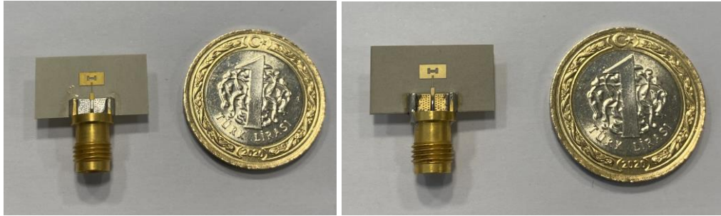
Şekil 4.5. Solda Kimyasal Aşındırma, Sağda LPKF ile Üretilen Çift Bantlı Antenler
