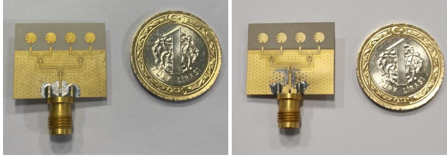
Şekil 4.11. Solda Kimyasal Aşındırma, Sağda LPKF ile Üretilen 28 GHz 4x4 MIMO Antenler
