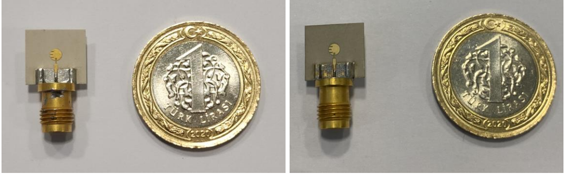
Şekil 4.9. Solda Kimyasal Aşındırma, Sağda LPKF ile Üretilen 38 GHz Tek Yama Antenler
