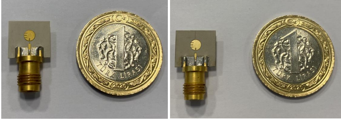
Şekil 4.7. Solda Kimyasal Aşındırma, Sağda LPKF ile Üretilen 28 GHz Tek Yama Antenler
