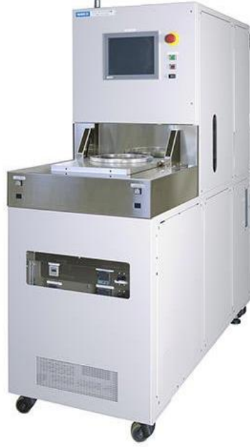
Şekil 3.15 Dielektrik ince filmlerin büyütüldüğü PECVD sisteminin bir görüntüsü
