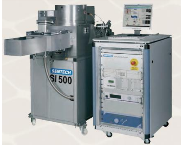
Şekil 3.10 Kuru aşındırma işleminin gerçekleştirildiği ICP RIE sisteminin bir görüntüsü
