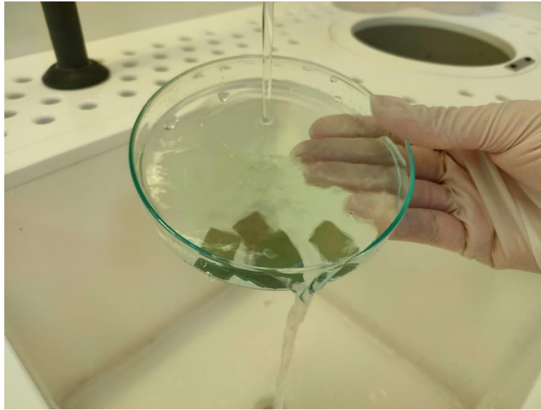
Şekil 3.6 Temizlenen alıtışların durulanma aşaması
