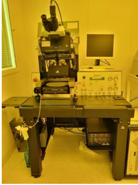
Şekil 2.26 Tez kapsamında kullanılan maske hizalama cihazı
