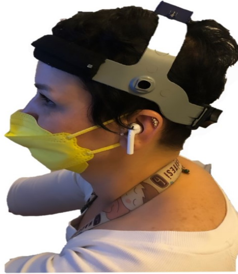
Şekil 3.2. Baş hareketi sırasında hızölçer cihazının katılımcıların başına sabitlenmesi
