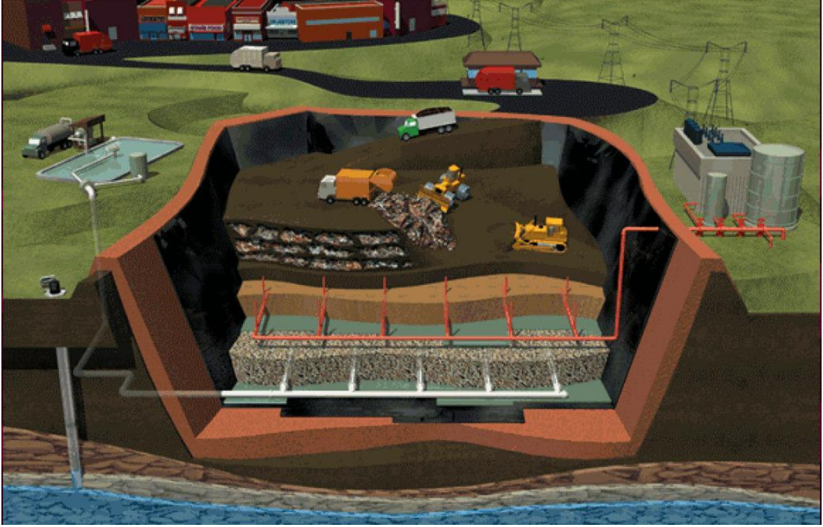
Şekil 2.1: Düzenli Depolama Sahası Kesiti [17]
