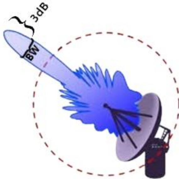
Şekil 2.1.2 Anten huzmesi ve 3dB huzme genişliği (BW).
