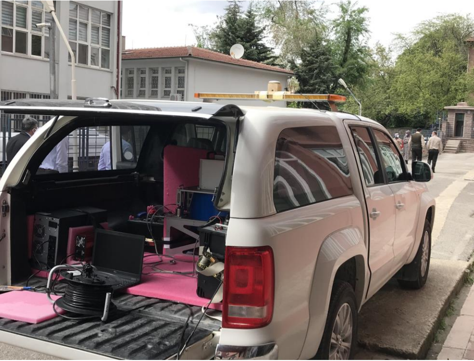
Şekil 5.3. Mobil yersel gravimetri sisteminin ilk prototipi. Taşıyıcı platform, SIMU, GNSS anteni ve güç üniteleri.
