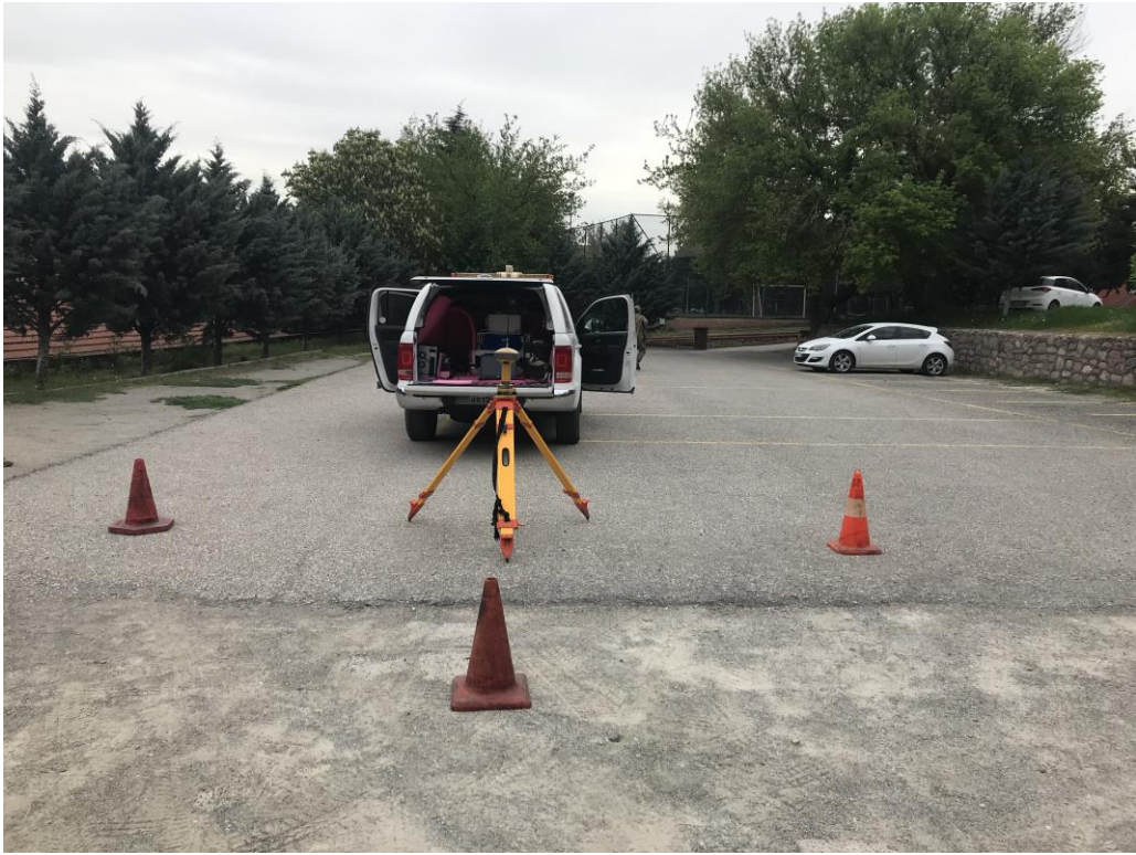
Şekil 5.6. Mobil gravimetri aracının ilk nokta üzerine çekilmesi, ölçü başlangıcı ve diferansiyel konumlama için GNSS referans istasyonu kurulumu.
