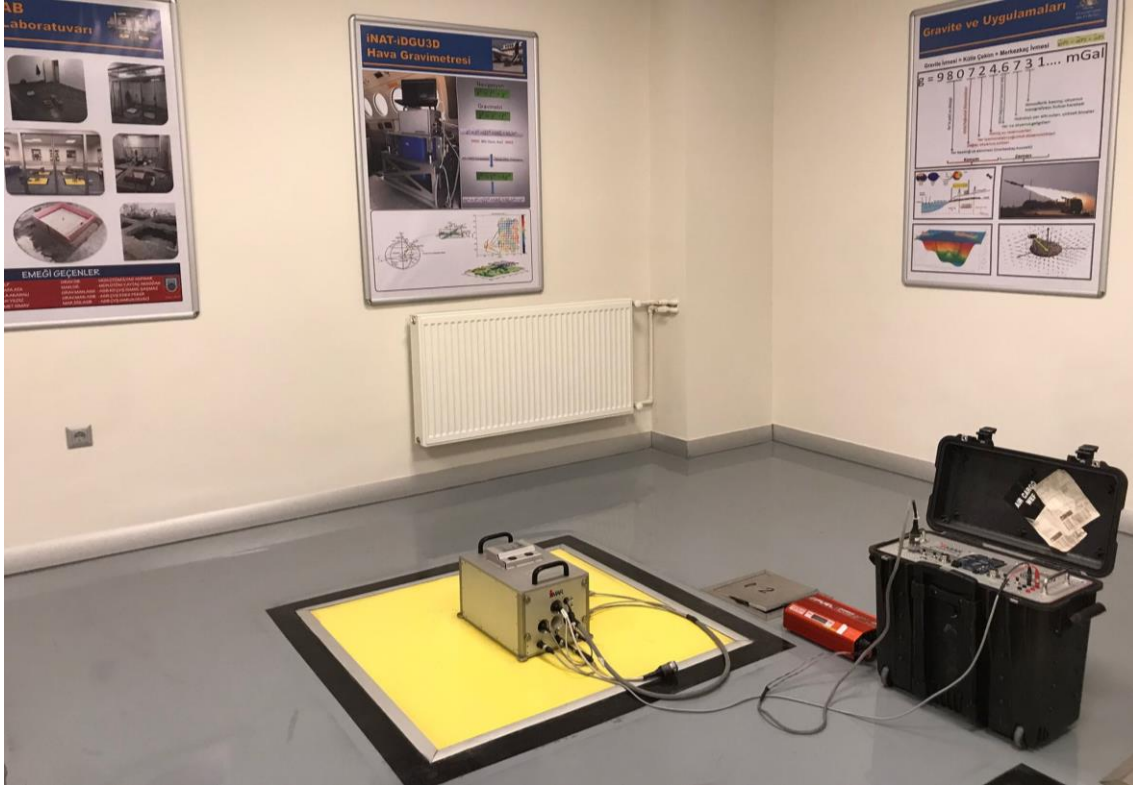
Şekil 3.6. Tez çalışmasında kullanılan SIMU ile TRGRAV-LAB laboratuvarında statik veri toplama çalışmalarından bir görüntü.
