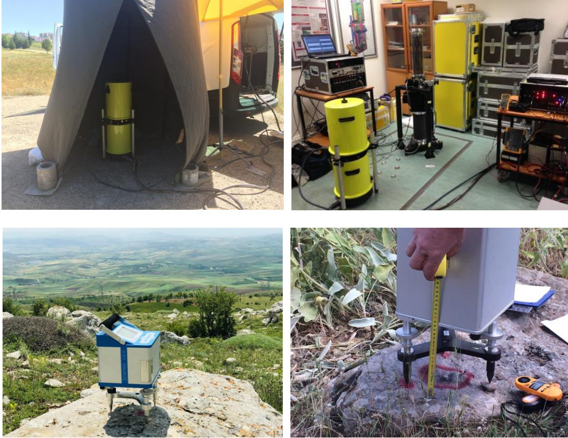
Şekil 1.3. Mutlak (üstteki) ve bağıl (alttaki) statik yersel gravimetri.
