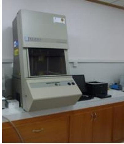
Şekil 3.4. Alpha Technologies MDR 2000B hareketli kalıp reometresi
