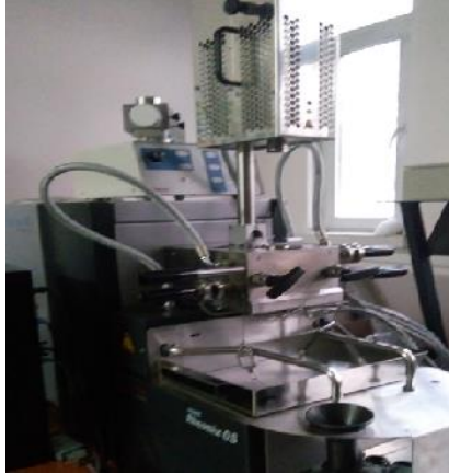
Şekil 3.3. Thermo HAAKE marka mikser sistemi
