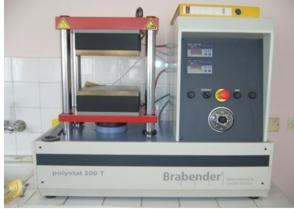
Ŗekil 3.6. Numune hazırlanmasında kullanılan Bradenber Polystat 200T hidrolik pres
