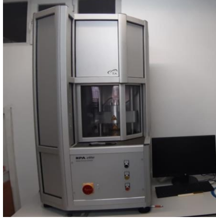
Şekil 3.9. TA Instrument marka RPA Elite kauçuk proses analizörü
