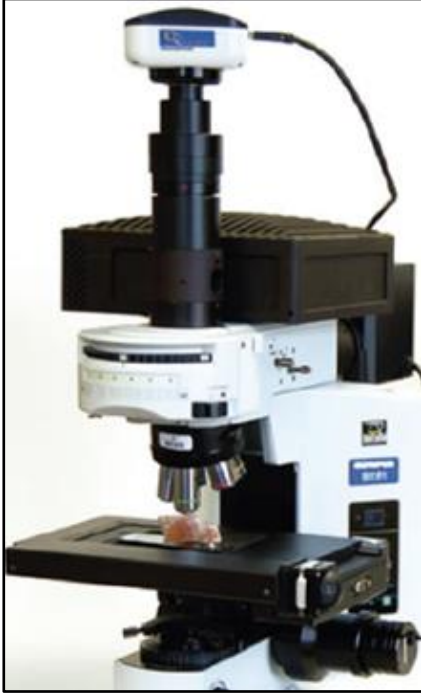
Şekil 3.3. Delta Nu Raman Mikroskobu (785 nm).
