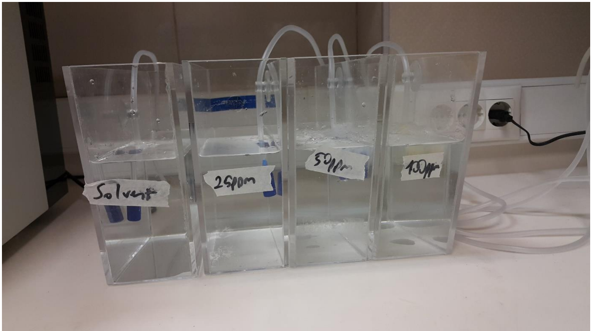
Şekil 3.3. Erişkin zebra balığında toksisite testi için tank düzeneği.
