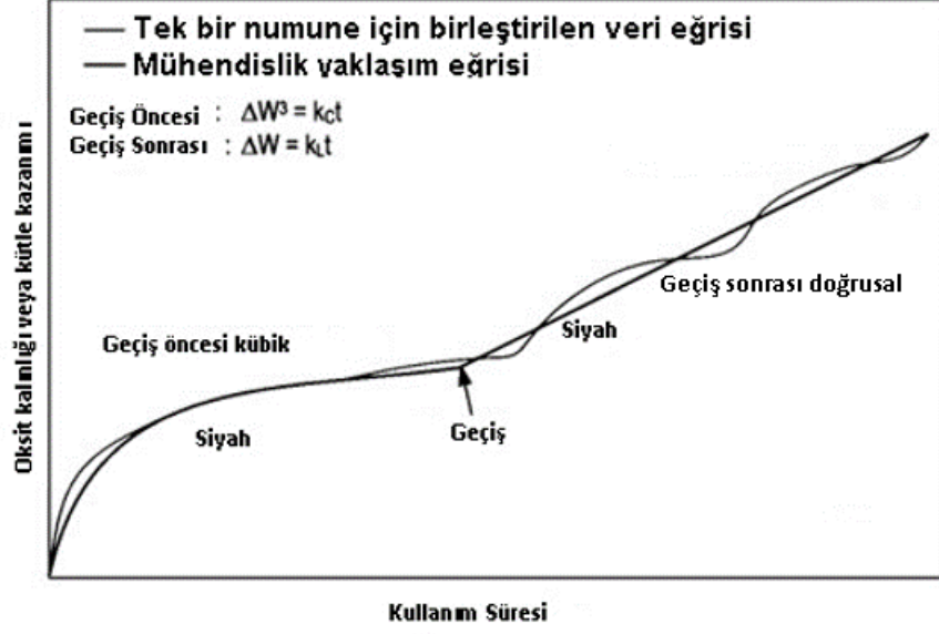
Şekil 1.2. 260-400°C Sıcaklık Aralığında Zircaloy-4'ün Korozyon Davranışının Şematik Gösterimi [6].
