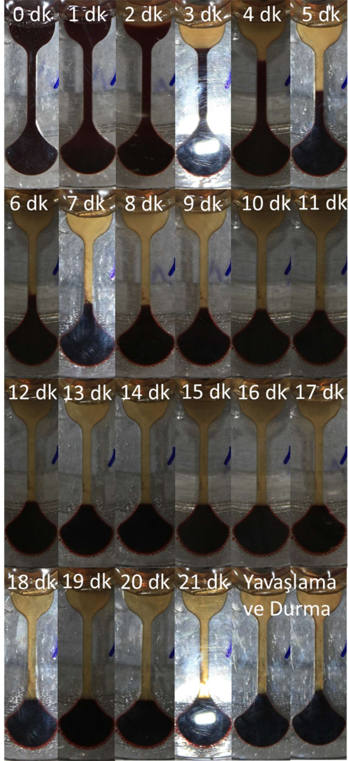
Şekil 36. Kadeh tasarımıda 1 numaralı kanalın santrifüj boyunca kırmızı kan hücrelerinin seviyesinin görüntüleri.
