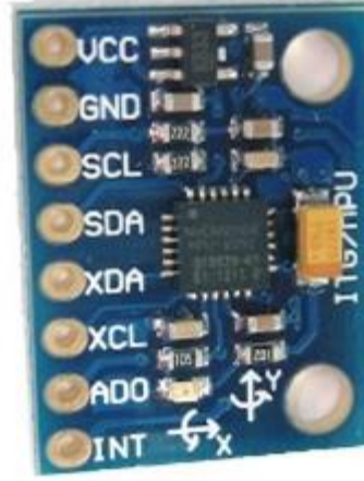
Şekil 2.2. MPU6050 duyarga grubunu barındıran devre modülü
