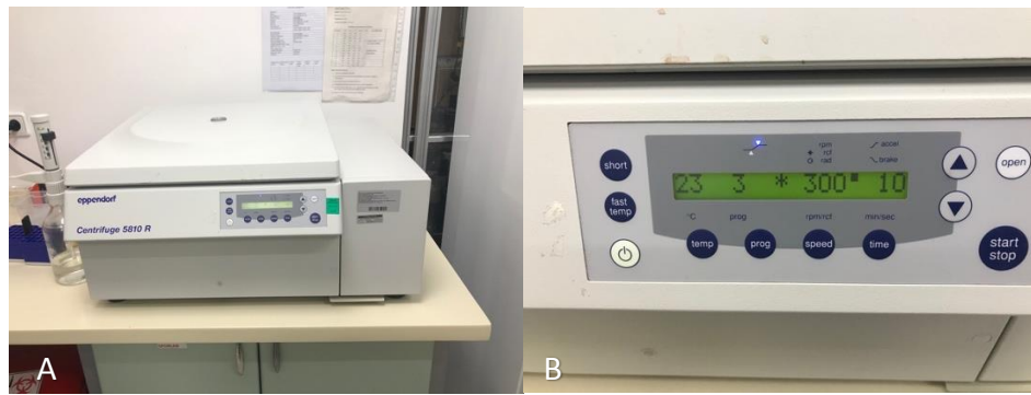
Şekil 3.16. A) Akış stometreye götürülen örneklerin santrifüj edildiği santrifüj cihazı(eppendorf Centrifuge 5810, Hamburg, Almanya)ve B) santrifüj ayarı
