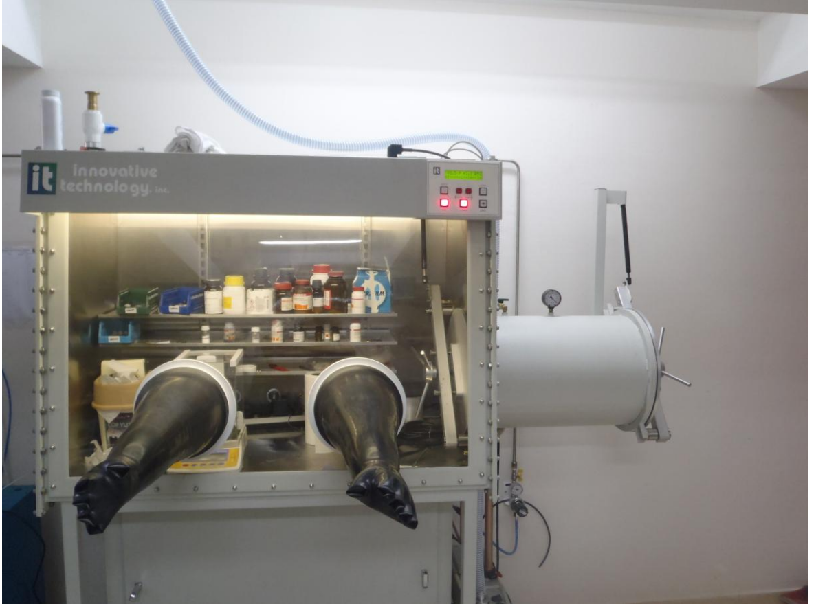
Şekil 3.9. Innovative Technology firması tarafından üretilen eldivenli kutu sistemi
