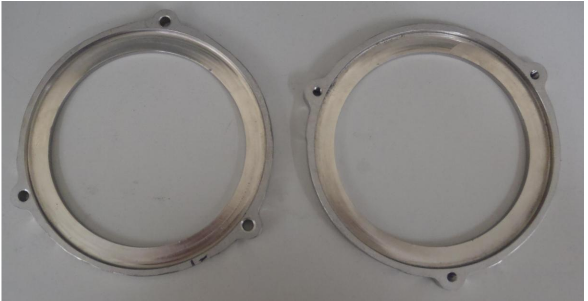
Şekil 3.7 Havanın kapağını sıkıştırmak için yaptırılan kelepçeler
