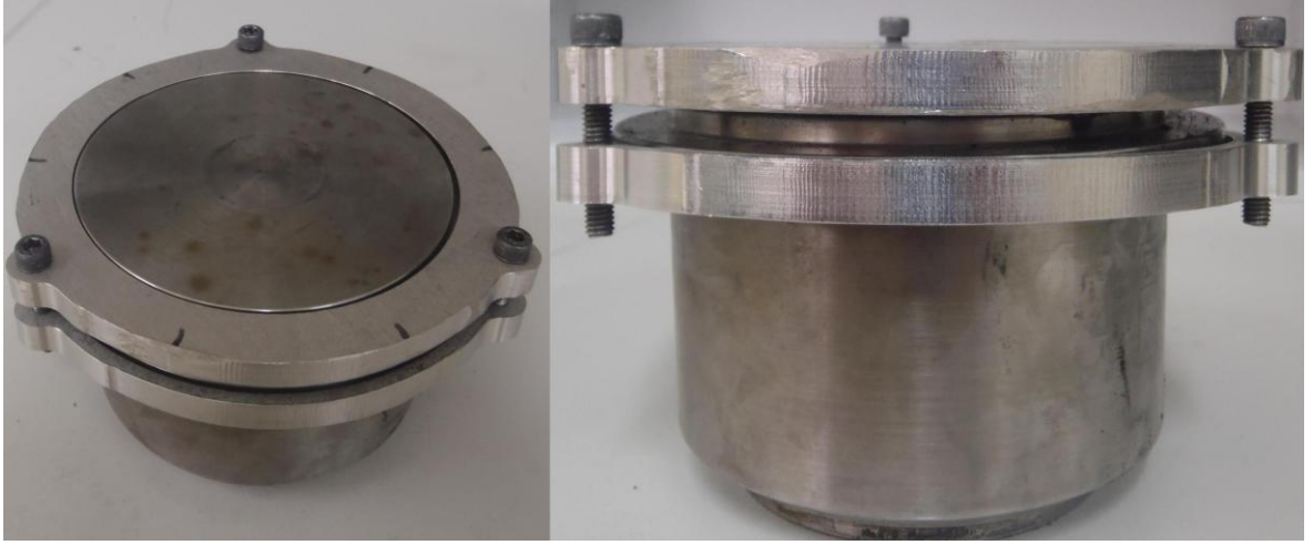
Şekil 3.8. Kelepçelerle sıkıştırılmış havan kapağı
