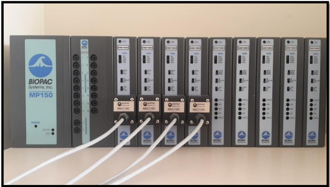
Şekil 3.16. Biopac® MP150 cihazı ve EMG100C EMG amplifikatörleri
