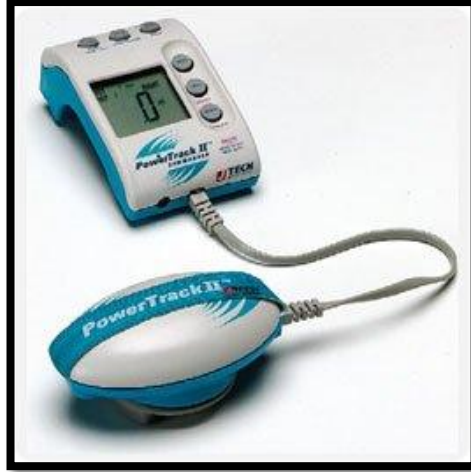
Şekil 3.13 . “Power track II” el dinamometresi
