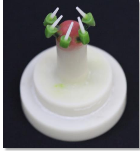
Şekil 3.16 Manşete alınmadan önce modelasyonların tijlenmesi
