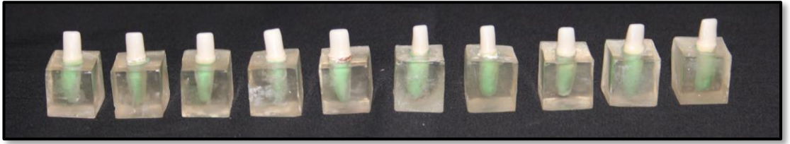
Şekil 3.24 Prefabrik Cosmo Post – IPS Empress Kor Örneği (Grup 3)
