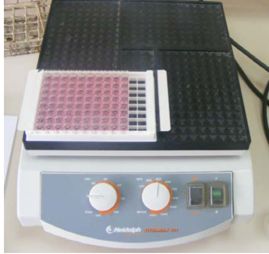
Şekil 3.3. Heidolph Titramax 101 orbital shaker cihazı ve 450 rpm’de inkübasyona bırakılan plak.
