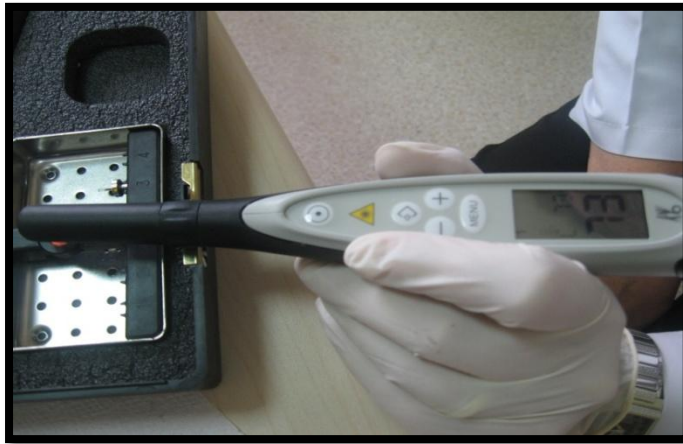
Şekil 3.2. Cihazın porselen disk ile kalibrasyonu
